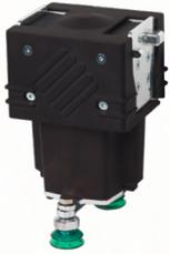
Der Double Vacuum Gripper kann ohne zusätzliche Vakuumpumpe Sauggreifaufgaben durchführen. Durch ein Zusammendrücken des Greifers wird ein starker Unterdruck an den Saugnapfen erzeugt, der je nach Beschaffenheit der Oberfläche auch das langfristige Anheben erlaubt.
